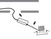
Após ligar o driver conecte os cabos da luminária e coloque-o dentro do forro
